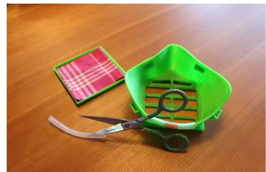
Abb. 4. Einlegen des Stofffilters in den Filteraufsatz und Aufschneiden des Schlauchs für den Kantenschutz. Der Schlauch kann mit Heftpflastern fixiert werden.
