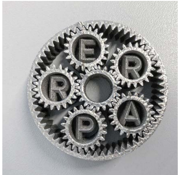
Abbildung 2: Das Planetengetriebe zeigt die Funktionsintegration im 3D Druck.
