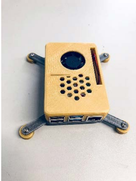
Abbildung 1: Dargestellt ist ein in einem FDM Drucker erstelltes Gehäuse für einen Mikrocomputer. (links) als Beispiel für das Rapid Prototyping.
