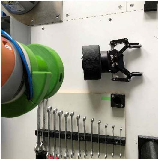
Abbildung 3: Ein Greifer und eine Werkzeugaufnahme (grün) gedruckt aus PLA Kunststoff.
