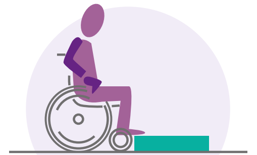
Die Stufe oder der Vorsprung verhindern den guten Verkehr des Rollstuhls
