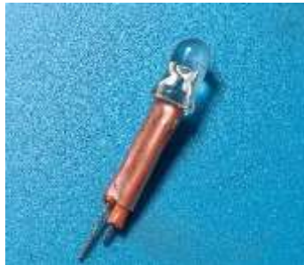
Abbildung 5: Eine kaltweiße LED mit isolierten Beinchen
