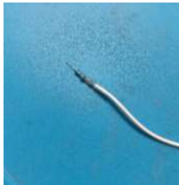
Abbildung 2: Widerstand am Kabel mit Schrumpfschlauch
