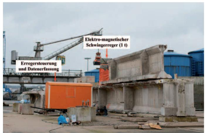
Statische Belastungstests sowie Schwingungsmessungen wurden an einem vorgespannten Träger einer echten Brücke durchgeführt und die Ergebnisse mit unterschiedlichen Methoden ausgewertet.
