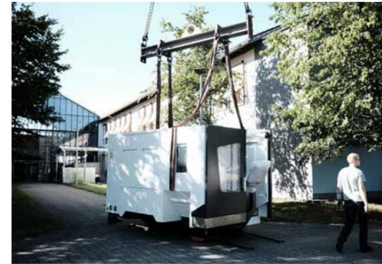
**R**echtzeitig vor Start des Wintersemesters im Oktober haben die Maschinenbauer am Umwelt-Campus eine moderne CNC-Maschine für Entwicklungsarbeiten im Bereich Industrie 4.0 bekommen. Zum Abladen der knapp 10 Tonnen schweren Maschine vom Typ Otpimum FU5 war ein 100t0 Kran erforderlich.
