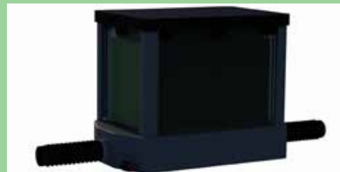
CAD-Renderbild des emerser Bioreaktors
