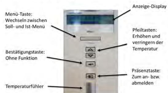
Bedieneinheit programmierbare Heizungssteuerung mit Hinweisen im Leitfaden für neue Mitarbeiter
