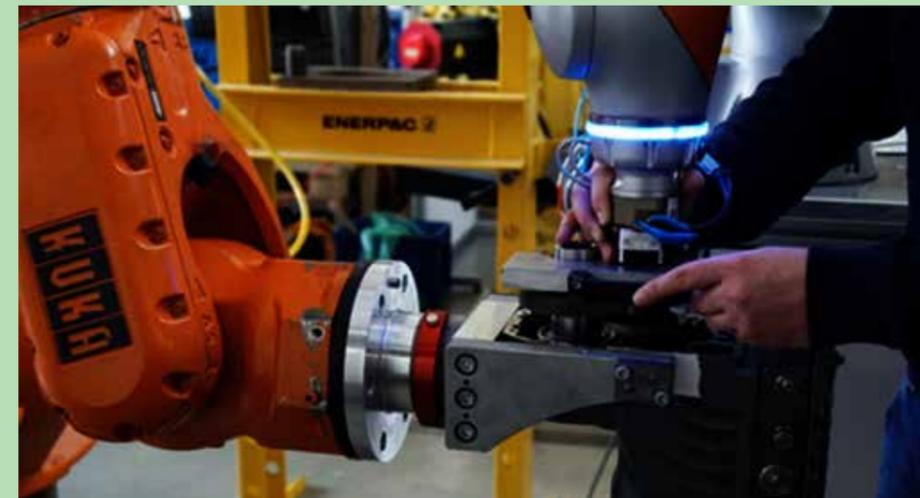
Der Mensch wird bei der Demontage von Getriebemotoren von zwei Robotern unterstützt. Der eine Roboter (links im Bild) hält den ca. 25 kg schweren Motor, der andere Roboter ist kraftregelt und hält während der Demontage das zu entnehmende Getriebe von oben. Die eigentliche Bewegungsführung erfolgt durch den Menschen.
