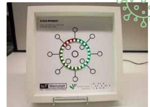
In einem Bilderrahmen eingebaut, symbolisiert ein leuchtender Neopixel-Ring das potentielle Infektionsrisiko.
