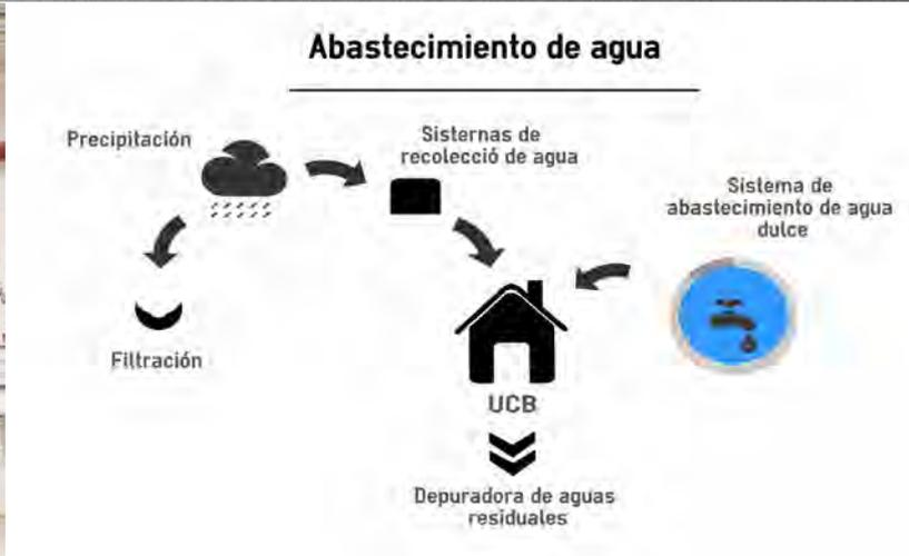
El Campus Ambiental Birkenfeld dispone de un sistema de recolección y almacenamiento de agua pluvial, la cual ahorra 800 – 1.000 m<sup>3</sup> de agua potable. En el 2014 el consumo de agua del campus se totalizó en 2.858 m<sup>3</sup>. Alrededor de un 1/3 de este consumo se puede cubrir con el uso de agua pluvial.
