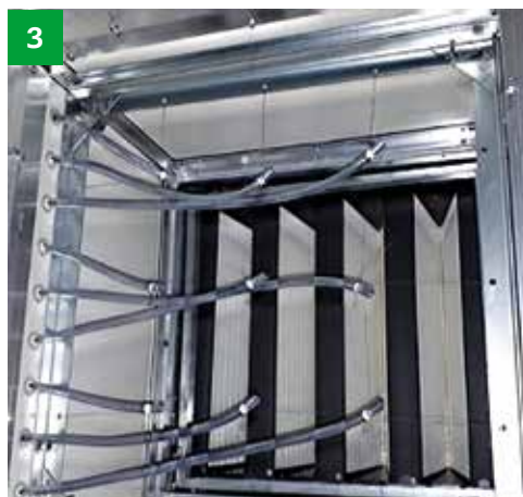
Verteilung der neun Partikelmessstellen über den Querschnitt
