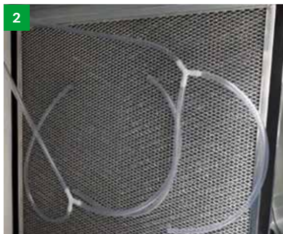
Positionierung der Ausgänge des Aerosolgenerators mit Gleichrichter
