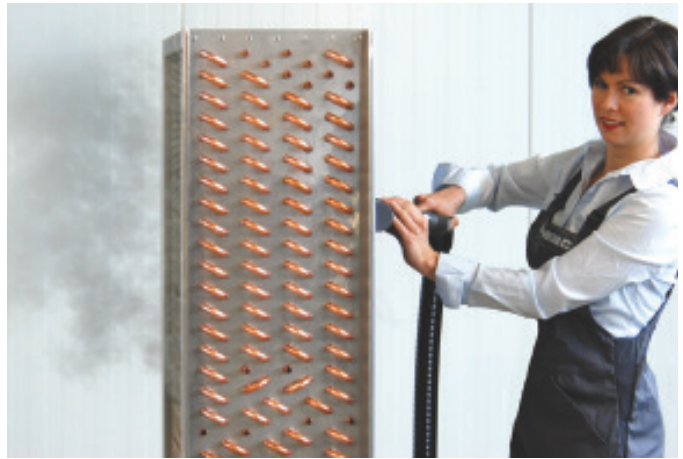
Bild 5 Durchgängige Dampfreinigung eines Wärmeübertragers
