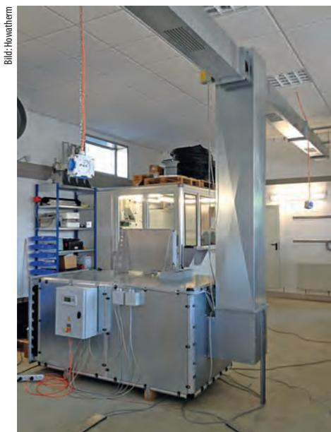
14 Versuchsaufbau (RLT-Gerät mit zwei Zuluftsträngen).
