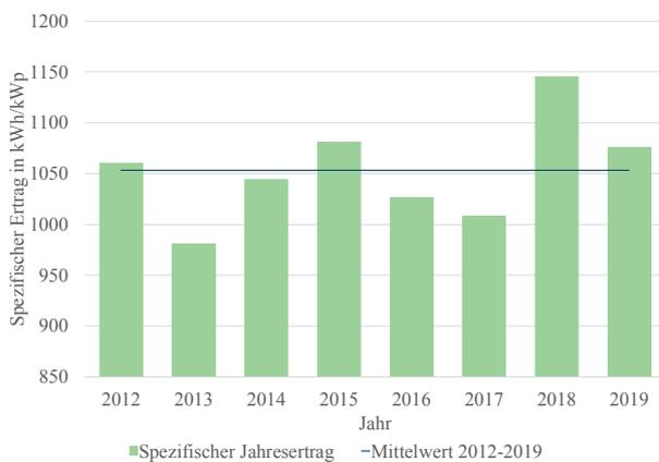
**Abbildung 5.4:** Gegenüberstellung der spezifischen Jahreserträge von 2012 bis 2019. Der langjährige Mittelwert des spezifischen Ertrags in Deutschland ist als blaue Linie dargestellt und beträgt 1.053 kWh/kW<sub>p</sub>.
